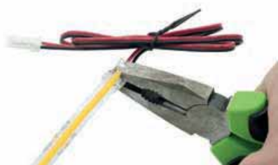
Páska a konektor se jednoduše zalisují kombinovanými kleštěmi.
